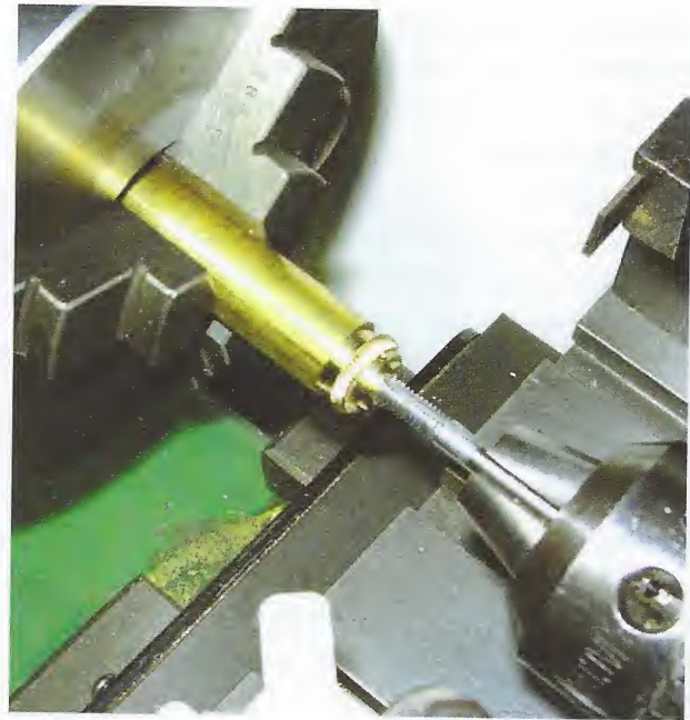
Fig. 28. Tapping The Thumbnut
