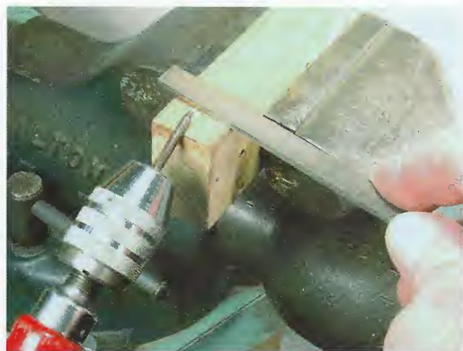
Fig. 9. Filing The Arbor Pivot
