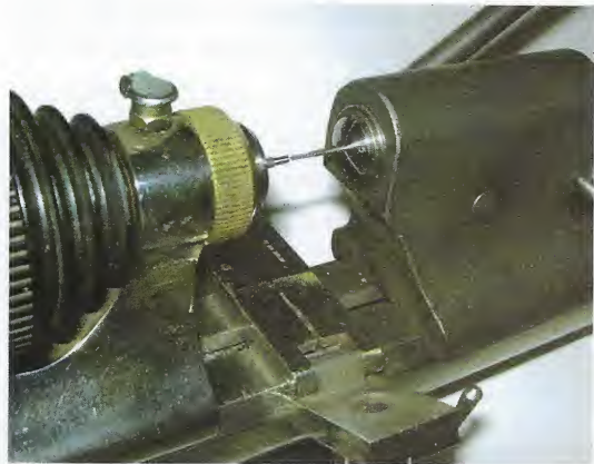
Fig. 25. Drilling A Rivet
