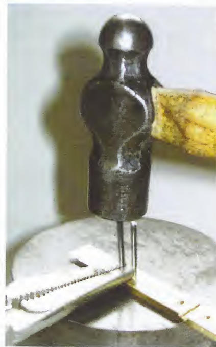
Fig. 20. Punching The Mainspring
