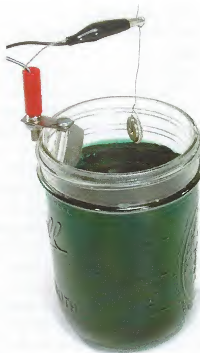
Fig. 12. Plating A Thumbnut
